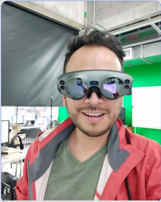
Los cascos de realidad mixta incorporan cámaras, pantallas y proyectores para ofrecer la sensación de imágenes suspendidas en el espacio. Fuente: Elder Tobar
