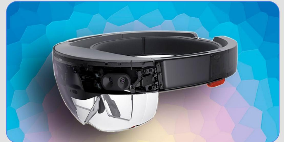
En la fotografía se puede observar un casco HoloLens de realidad mixta
